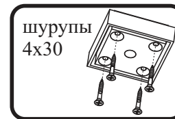
схема монтажа опоры
