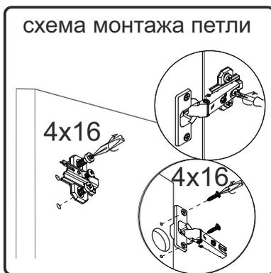
Регулирование зазоров и положения дверей с петлями
